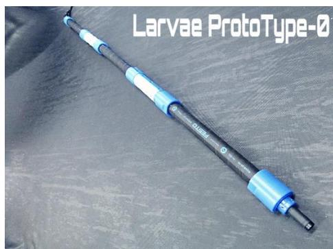
図7 配管検査ロボット
